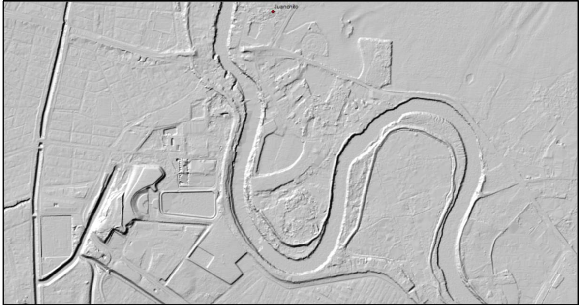
Fig. 24. Modelo de sombras generado a partir de LiDAR del corredor Río Cauca, Zona Juanchito
