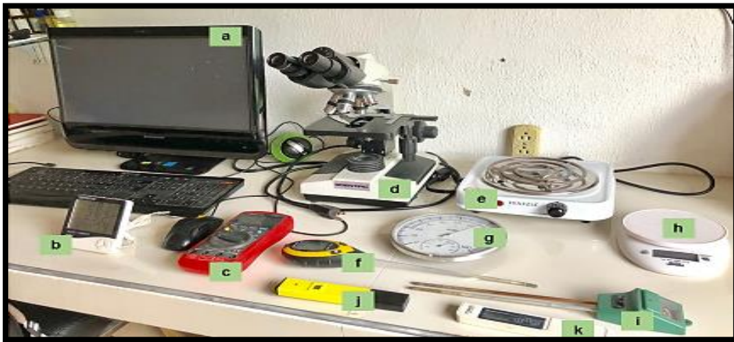
Figura 8. (a) Computador, (b) medidor de temperatura y humedad ambiental, (c) multímetro, (d) microscopio, (e) estufa, (f) medidor de humedad suelo, (g) medidor de humedad ambiental (f) Medidor de humedad bajo alto, temperatura °C Y F, Ph, luz alto o bajo para
