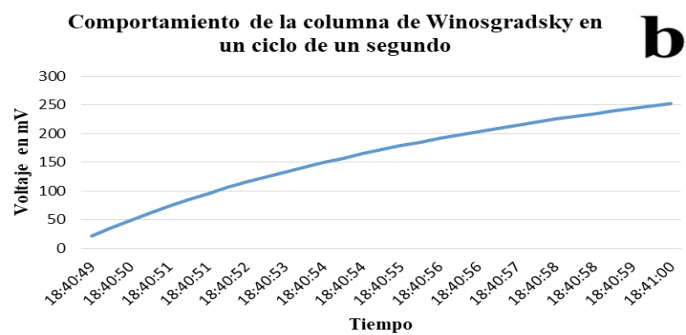
Figura 38. Comportamiento bioeléctrico de la columna de Winogradsky en un ciclo de un segundo. Es un método práctico para analizar un sustrato desde una perspectiva biogeoelectrónica en una columna que se constituye como una muestra del ecosistema de donde procede
