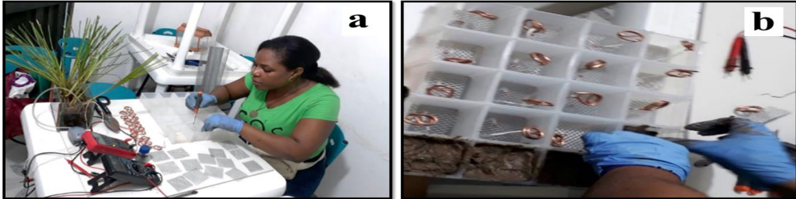
Figura 14. Placa de plástico para el montaje de la biogeobatería con 20 cavidades (a) configuración de electrodos en serie y operación de llenado con el sedimento proveniente de zona aluvial con influencia de aguas residuales (b)
