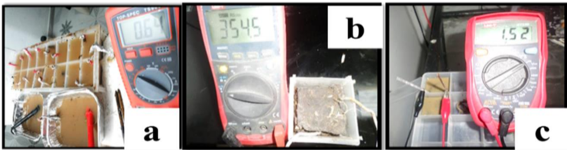
Figura 25. Potencial sustrato pantanoso (0.64 v). (b) potencial sustrato orgánico tipo compost (0.35 v). Potencial e sustrato limoso/ arenoso proveniente de mina a cielo abierto (1.5 v)
