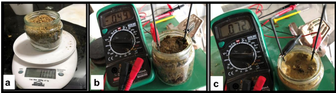
Figura 39. (a) Sedimento pesado (100gr), (b) medición de potenciales en seco (-0.049 v), (c) medición de potenciales hidratado (0.072v)
