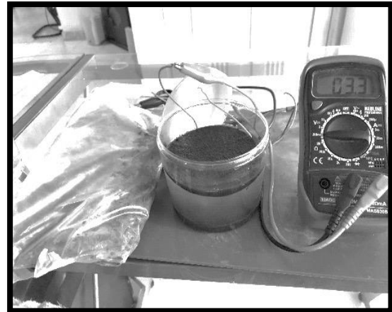
Figura 10. Celda experimental para la generación de señales de autopotencia (SP) con el sedimento configurada con electrodos de grafito en posición horizontal estática.
