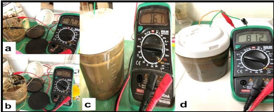
Figura 30. Condiciones iniciales biorreactor Mudwatt. (a) Voltaje de arranque con electrodos de grafito, (b) voltaje 60 minutos después con electrodos de grafito (c) voltaje de arranque con el electrodo de grafito en forma de disco y (d) voltaje
