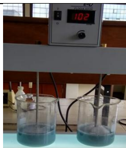
Foto 18. Ensayo de jarras con NaOH 1M en solución sintética de Cr (III). Equipo floculador EQUIFAR
