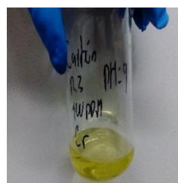
Foto 19. Ensayo de jarras con NaOH 1M en solución sintética de Cr (VI). Equipo floculador EQUIFAR
