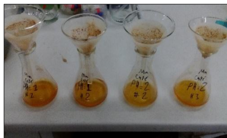
Foto 10. Separación del bioadsorbente de la solución sintética Fuente: Captura propia
