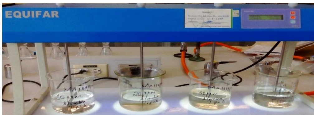
Foto 14. Ensayo de jarras con alumbre al 1% m/v en solución sintética de Mn (II). Equipo floculador EQUIFAR.
