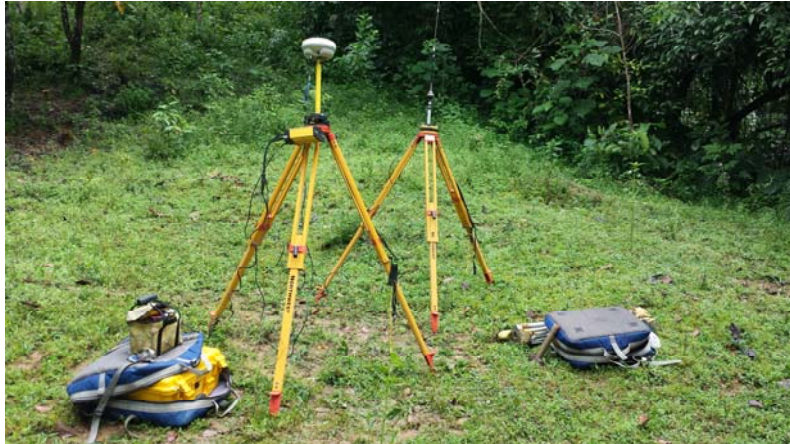
Figura 3 Equipo GPS (Trimble). Elaboración Propia
