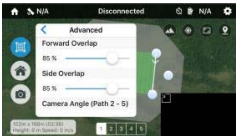
Figura 10. Selección de Traslape entre Fotografías. (Elaboración Propia Aplicación Altizure)
