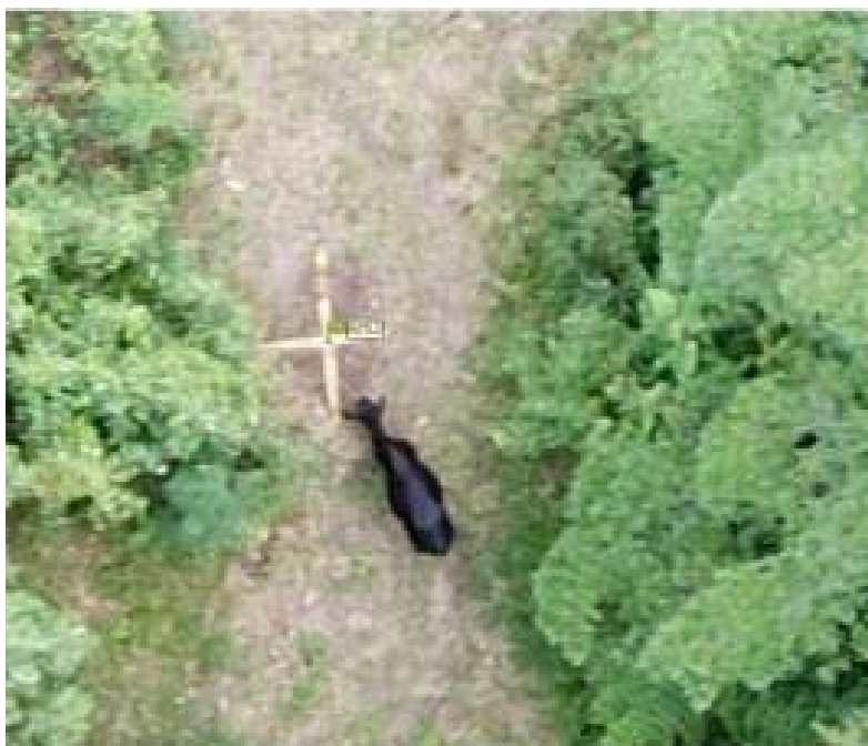
Figura 15. Identificación de Puntos de Control. (Elaboración Propia)
