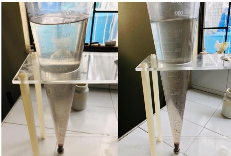
Figura 11: Cono de Imhoff para la determinación de volumen de floc
