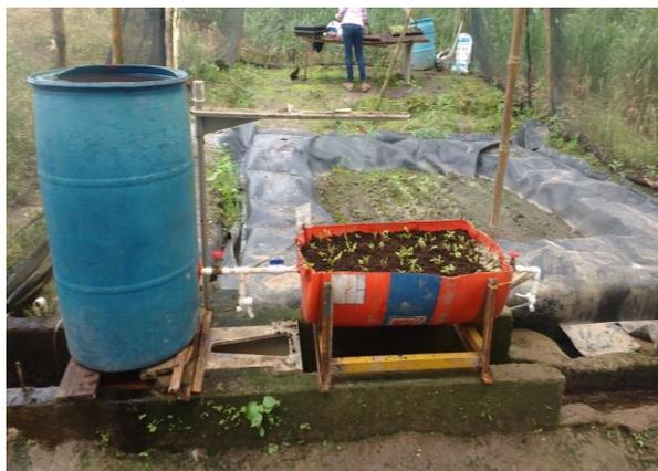
**Figura 2.8** Vista general del humedal subsuperficial experimental de 0,5 m<sup>2</sup> de área.
