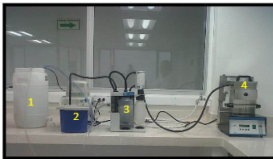
Figura 3. Montaje para digestión. Fuente: Universidad Antonio Nariño, (2015).
