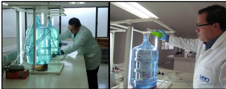
Figura 2. Montaje de los fotobiorreactores para la producción de Chlorella sp.
