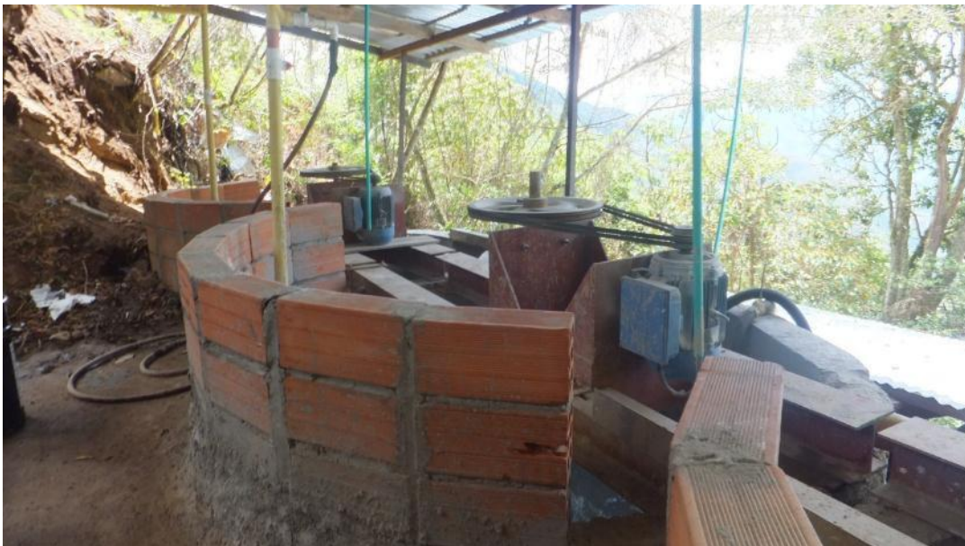
Imagen 8. Tinan de agitación (Proceso de Cianuración)
