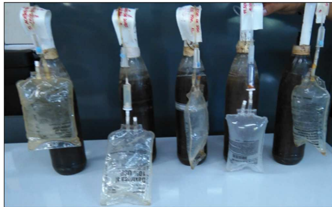
Figura 4 Detalle de los reactores anaeróbicos
