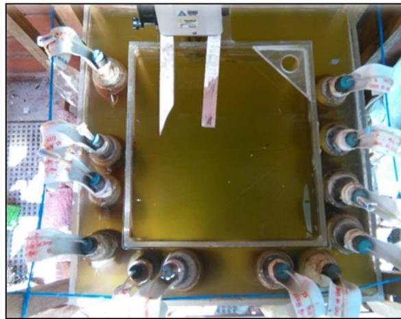
Figura 3 Montaje para la evaluación de la degradación anaeróbica
