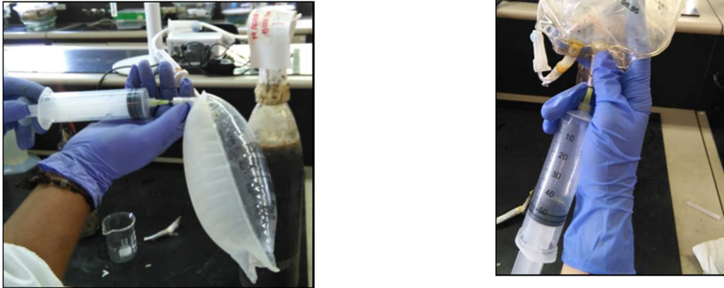
Figura 6 Toma de muestra del biogás generado para determinar la calidad del metano.
