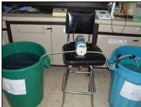
Figura 10 Montaje final para llevar a cabo la neutralización.
