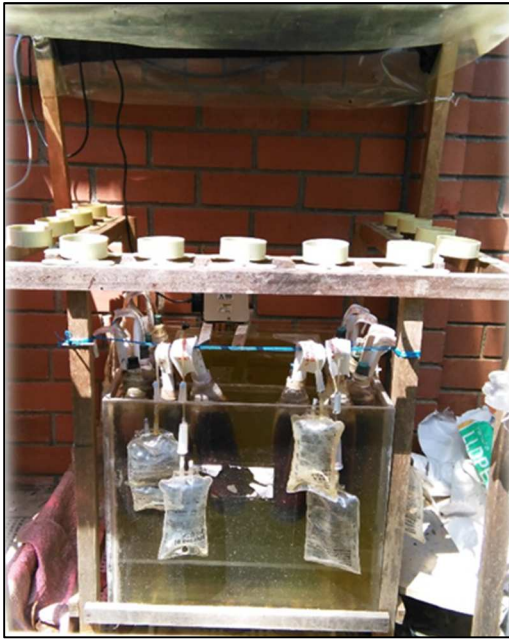
Figura 3 Montaje para la evaluación de la degradación anaeróbica
