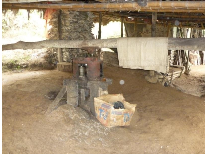
Figura 9. Trapiche tracción animal estructura artesanal panelera propiedad del señor Manuel Salvador Díaz (Vereda Ídolos) Fuente: Propia
