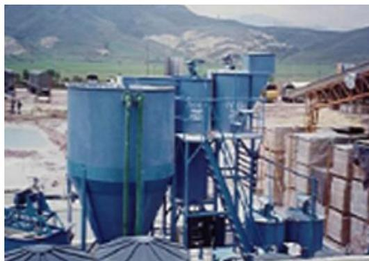
**Ilustración 3 Sedimentador. Fuente: Protón, 2014**
