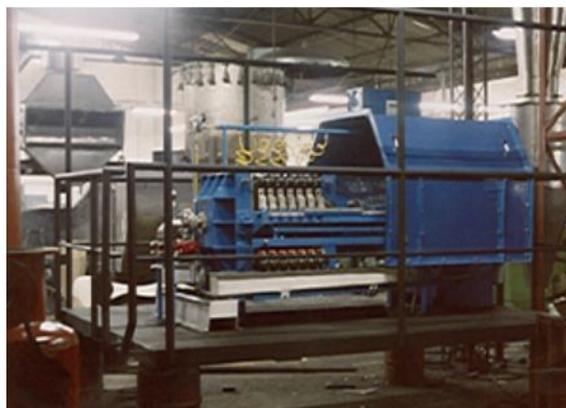
**Ilustración 5 Filtro prensa. Fuente: Protón, 2014**
