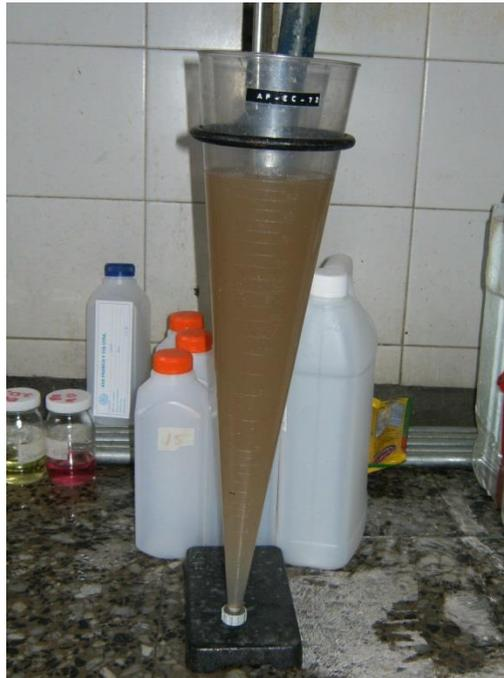
**Ilustración 10 Medición de Sólidos sedimentables**
