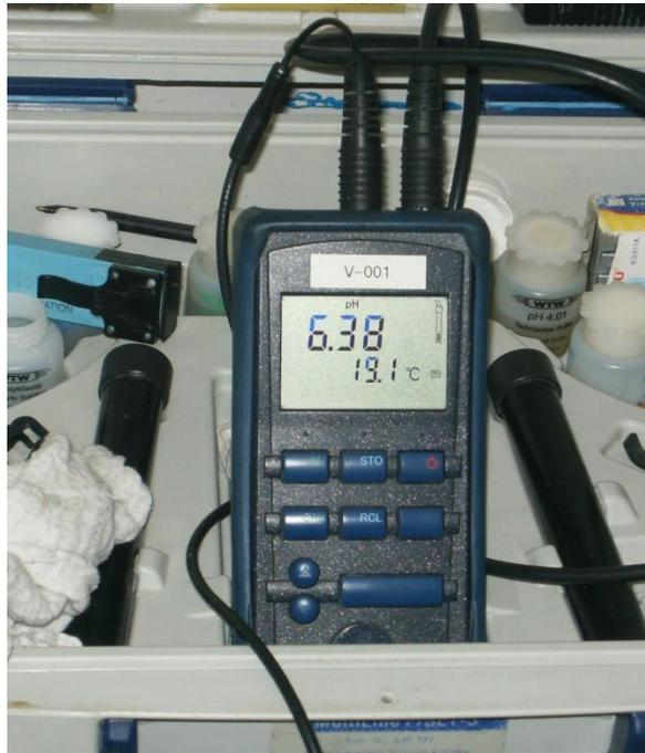
**Ilustración 11 Medición de pH**
