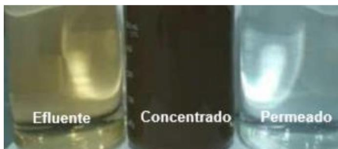
**Ilustración 7 Efluente, concentrado y permeado del equipo. Fuente: Purifics, 2016**
