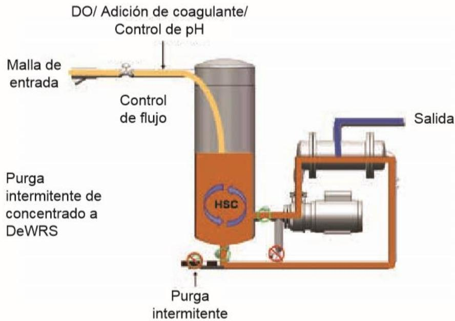
**Ilustración 8 Flujo de proceso. Fuente: Purifics, 2016.**
