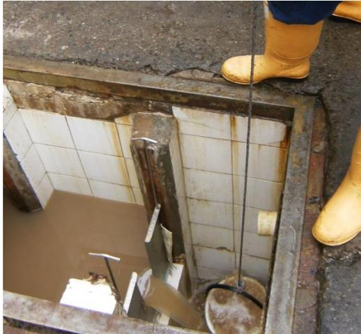
**Ilustración 9 Toma de muestras del efluente de la planta**
