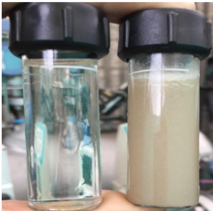
**Ilustración 12** Afluente y efluente del sistema. Fuente: Propia 2017
