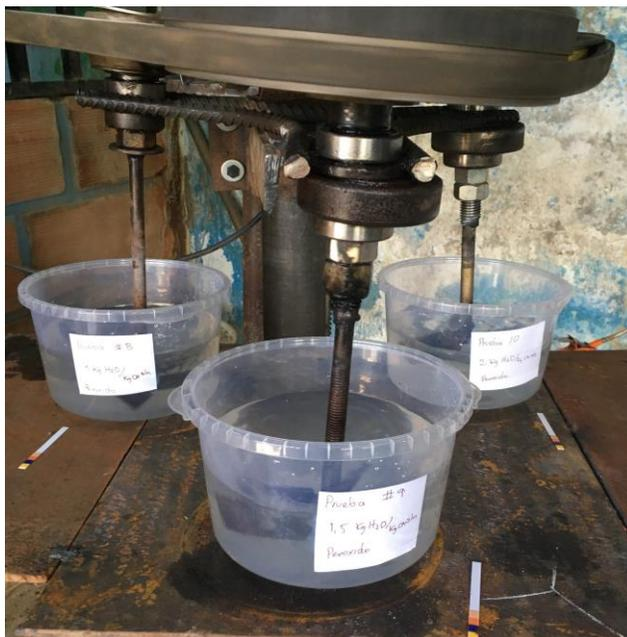
Figura 3. Pruebas experimentales con adición de peróxido de hidrógeno.
