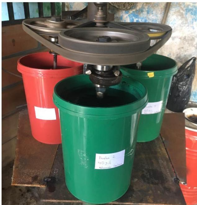
Figura 2. Tanques con agitación, en los cuales se realizaron las pruebas experimentales de adsorción con carbón activado.
