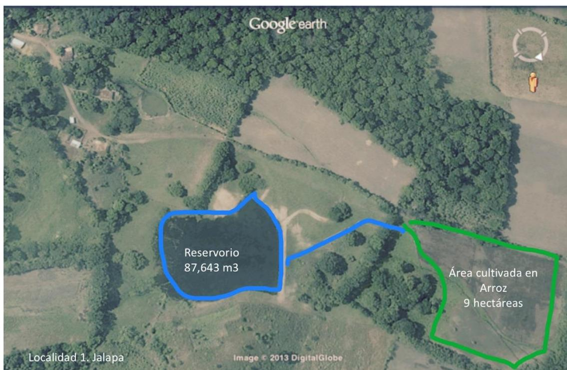
Figura 2. Esquema de cosecha de agua para riego de arroz en la Localidad 1. Google Earth. 2013
