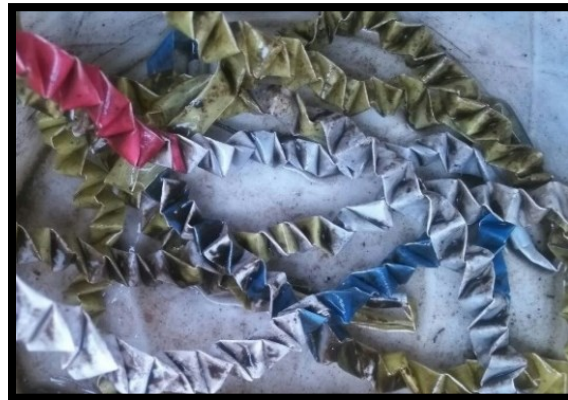
Ilustración 21. Muestra de material de contacto con biopelícula en su superficie.
