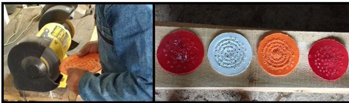
Ilustración 22 Adaptación de tapas plásticas para elaboración de falso fondo
