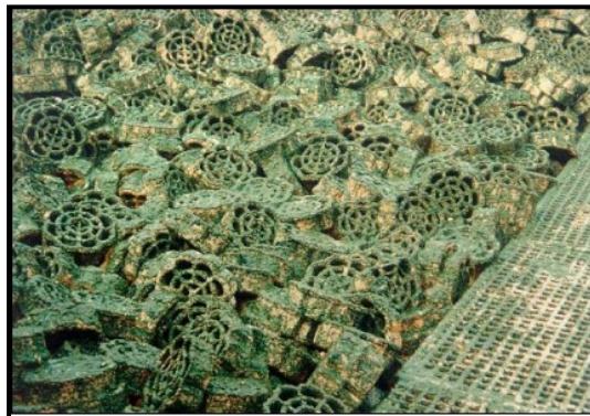
Ilustración 5. Medio filtrante de un FAFA a gran escala.
