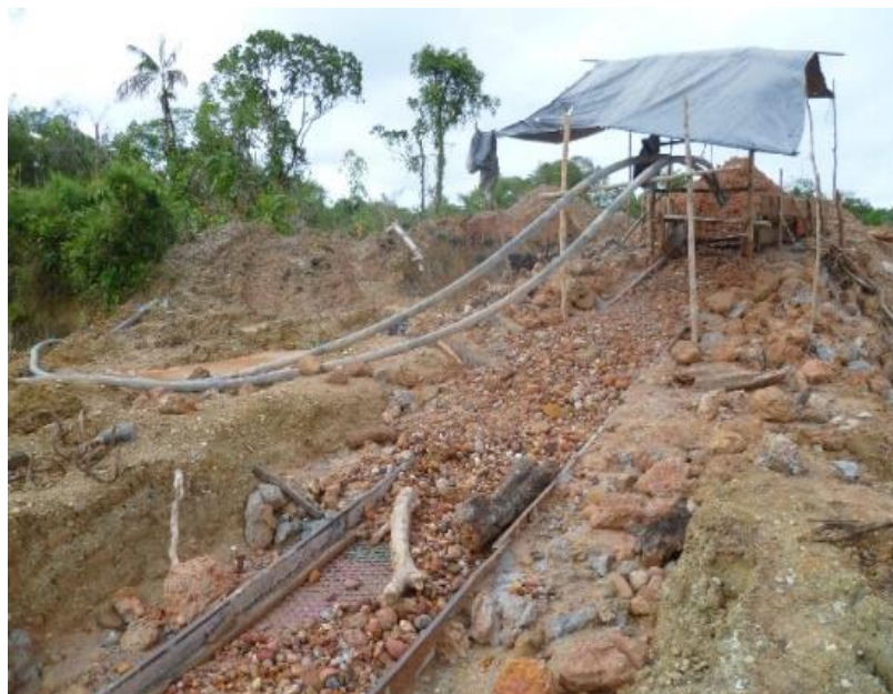
Figura 3-24. Materiales lavados en el canalón superficial
