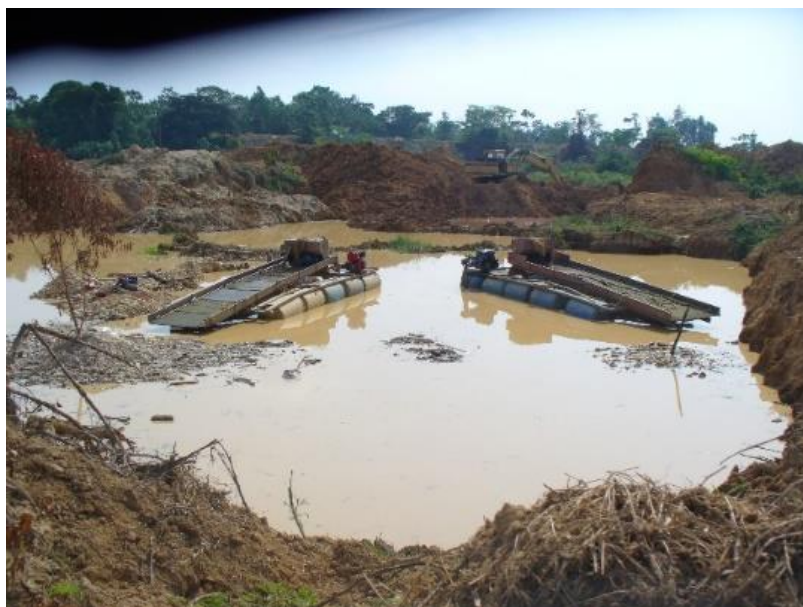
Figura 3-12. Empleo de mini barcazas acondicionadas con canalones entapetados
