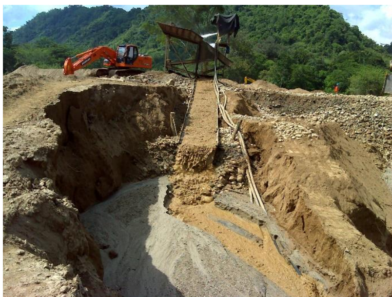
Figura 3-48. Lavado de minerales en criba metálica y canalón
