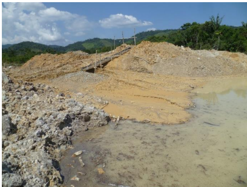
Figura 3-34. Canalón superficial y disposición de residuos a campo abierto generados por el lavado y amalgamado
