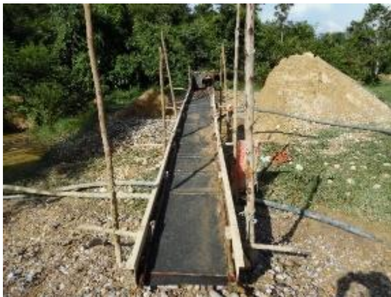
Figura 3-56: Canalón aéreo entapetado
