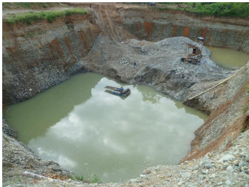
Figura 3-21. Estanque formado por frente minero inactivo, se afectó el nivel freático del río Quinamayo
