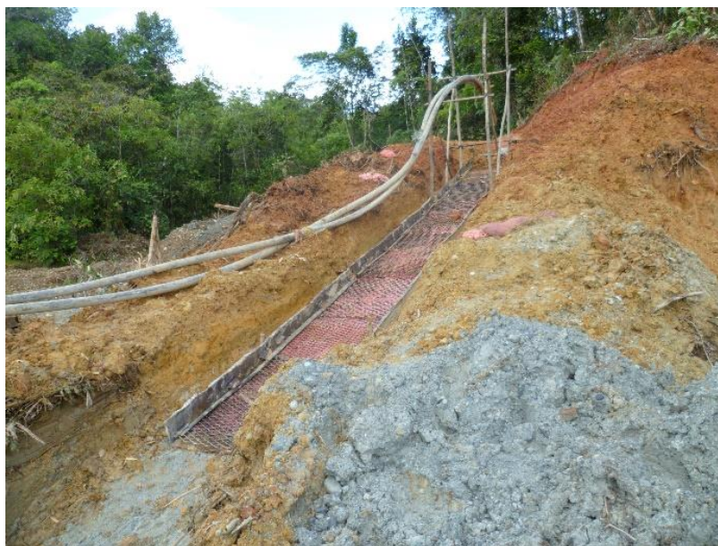
Figura 3-26: Alistamiento de canalón para lavado de minerales
