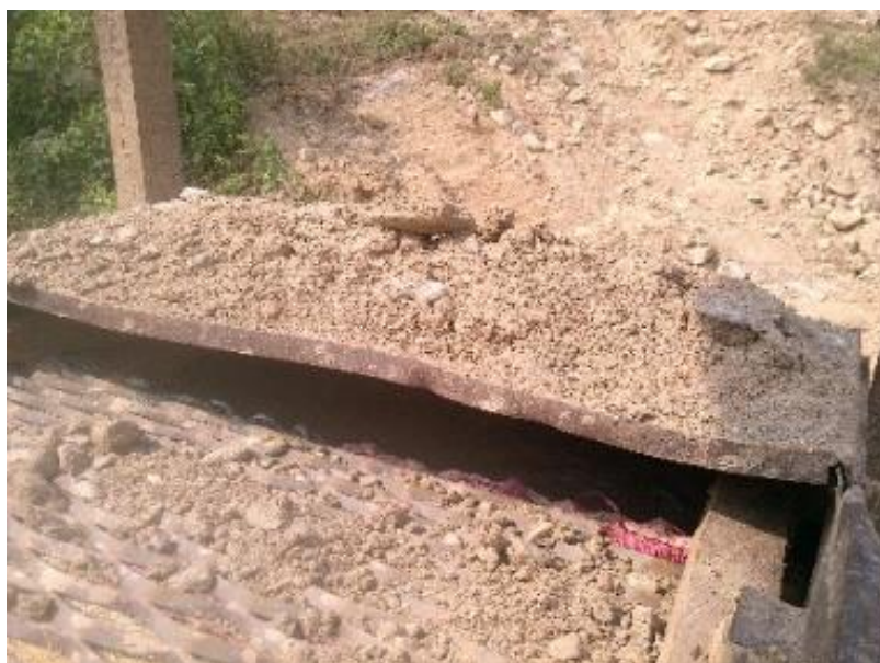
Figura 3-54: Minerales en canalón de la criba
