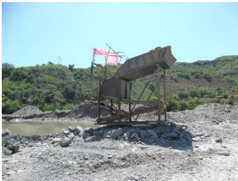
Figura 3-55. Criba utilizada en la explotación aurífera sobre el río Sambingo en el departamento del Cauca
