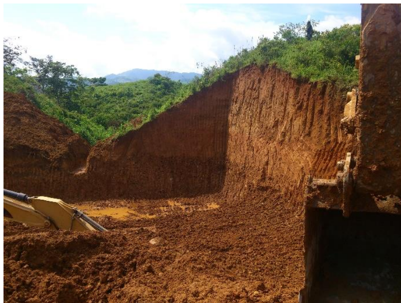
Figura 3-17. Perfil del suelo explotado, expuesto a procesos oxidativos y potenciales liberaciones de metales
