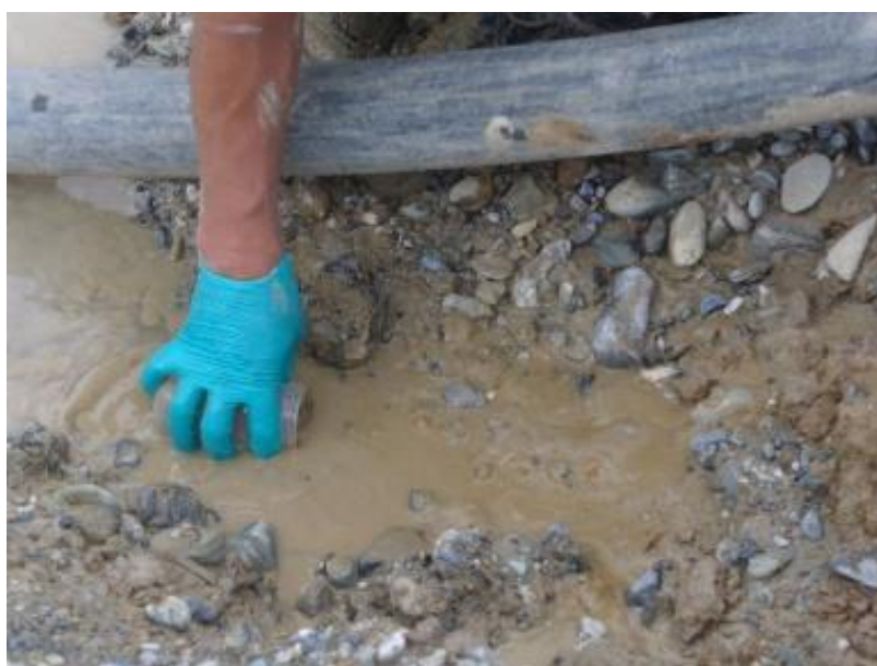
Figura 3-3. Toma de muestra puntual de sedimentos
