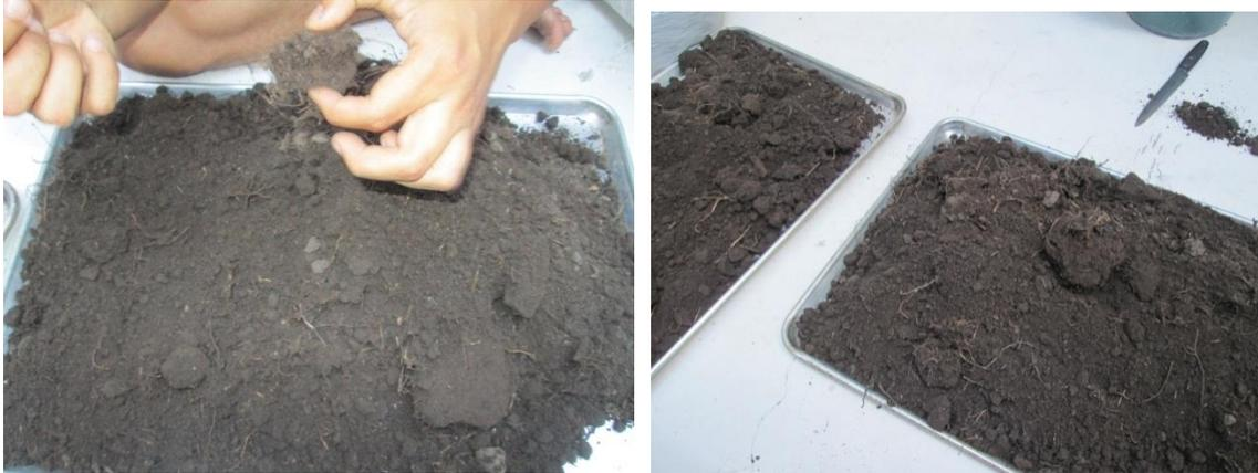
**Figura 3.13** Proceso de Preparación de muestras para determinación de C.O y N.T
