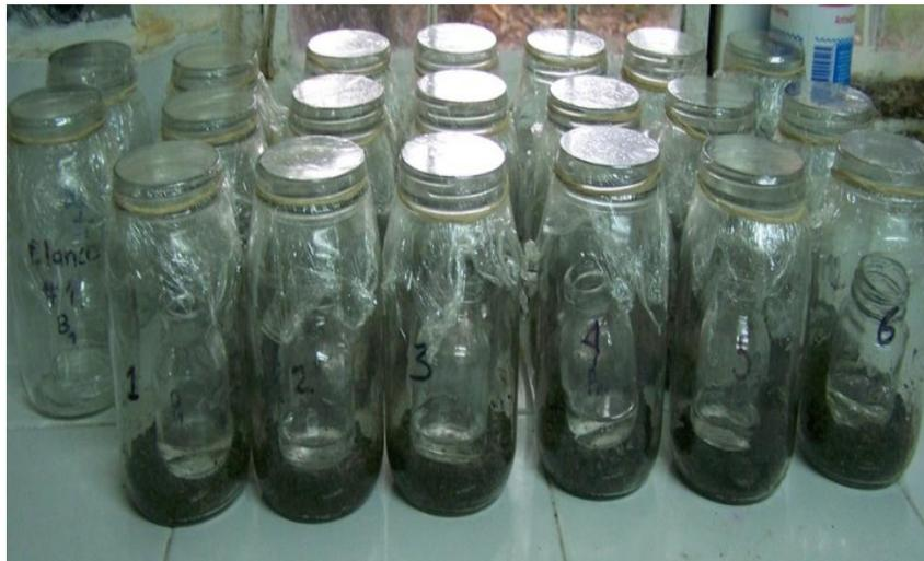
**Figura 3.15** Proceso de prueba de respiración del suelo TRmgCO mediante la utilización de Frascos de 500ml los cuales contienen las muestras del suelo en estudio con sus respectivos tramientos en frascos de 100ml, herméticamente sellados para evitar pérdidas de CO<sub>2</sub> liberado. Fuente: Autor
