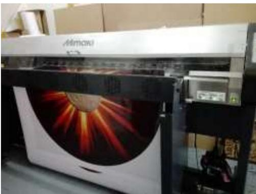
**Figura 6.4** Impresora de inyección de tinta UV Mimaki
