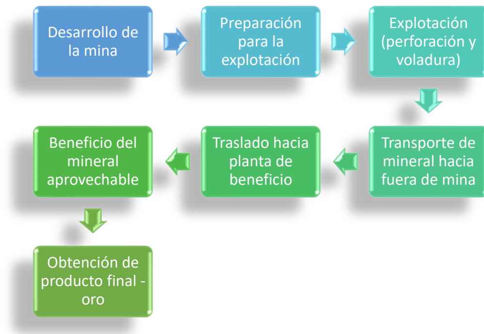
Figura 8. Proceso para la extracción de minerales en minas subterráneas.
