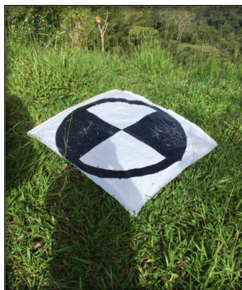
Figura 9. Diseño de marca empleada en el fotocontrol.
