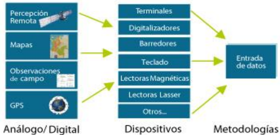
Figura 2 Componentes del subsistema de entrada de datos
