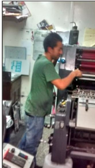
**Figura 12. Fotografía empleado sin elementos de protección personal.**
