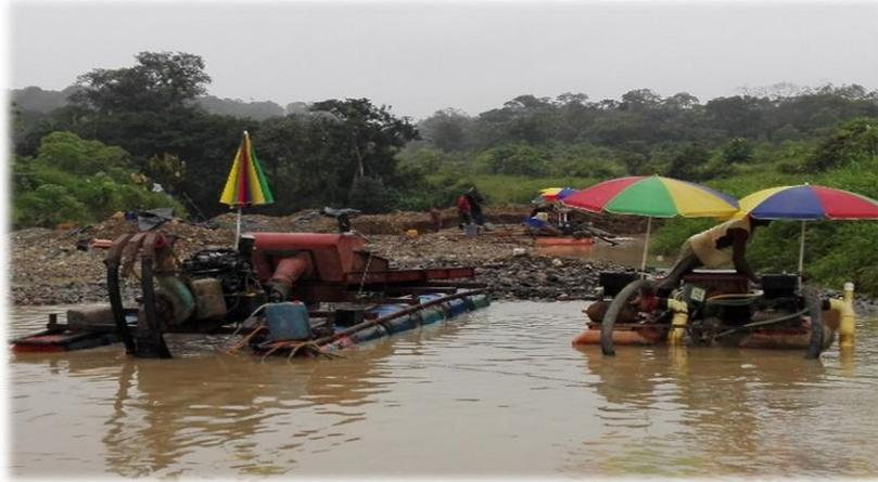
***Figura 3. Dragas utilizadas para la extracción de oro. Río Chato, Tadó.***
