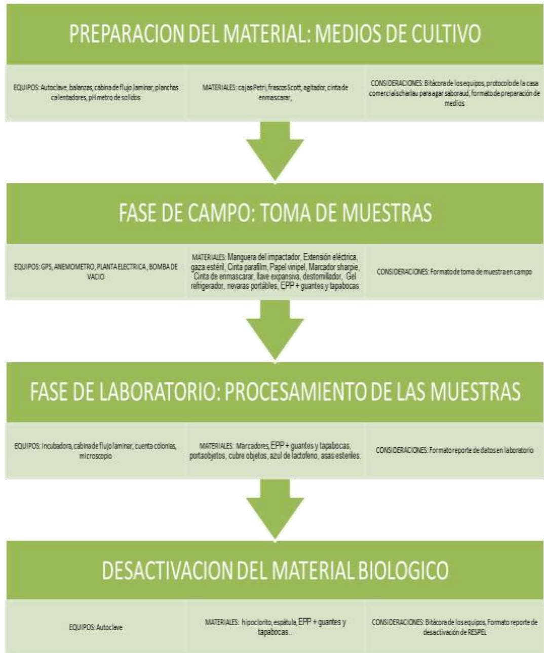
Figura 4. 2. Etapas del monitoreo con el Impactador de cascada Fuente: Autor, 2016.
