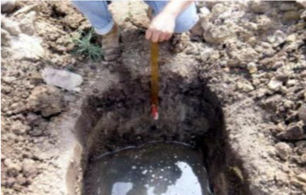
Figura 5. (Calicatas para evidenciar los NF a diferentes profundidades). Estudio de nivel freático Ingenio La Cabaña.
