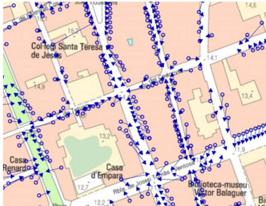
Figura 2: Comparación de los resultados del geocodificador del ICC y del Censo de edificios 2011 en una zona del centro de Vilanova y la Geltrú. Los segmentos unen los puntos correspondientes a las dos fuentes.
