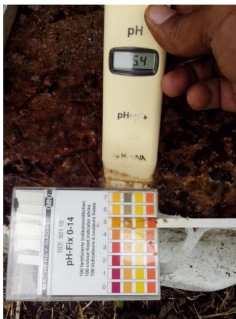
Figura 18. Toma de pH a las muestras de las unidades experimentales con dispositivo electrónico y cinta de colores
