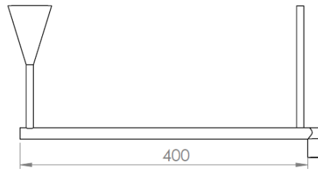
Figura 4-4. Tolva, barril acotado y salidas de gas y sólido.
