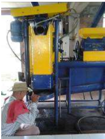
Figura 20. Desmucilaginador mecánico (a) y direccionamiento del entrada tratamiento (b).
