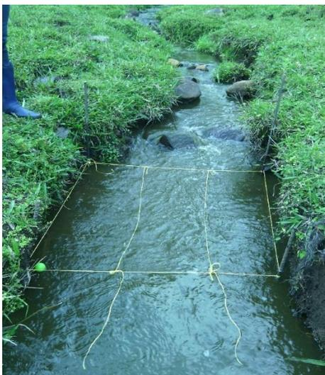
**Figura 10. Midiendo el tiempo con el pin pon para calcular el caudal**
