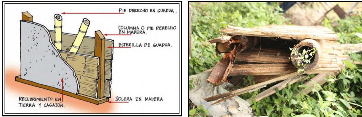
Ilustración 4. Bahareque hueco o aligerado
