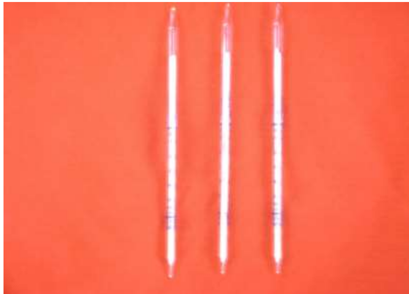
Figura 11. Tubos calorimétricos detectores de Mercaptanos.
