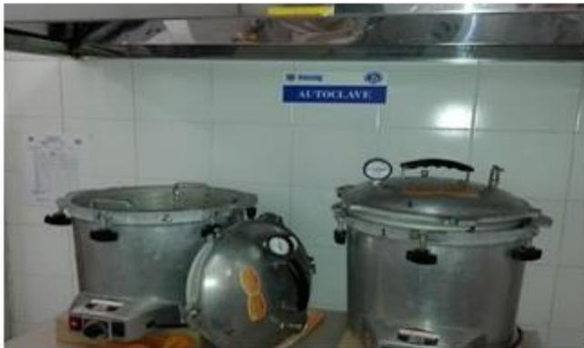
Diferentes instrumentos utilizados en la fase experimental de laboratorio como microscopios para medir el crecimiento celular, balanza digital para medir la masa de las diferentes sustancias utilizadas, autoclave para esterilizar todo el material utilizado.
