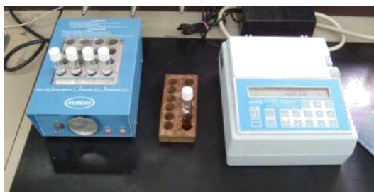
Figura 20 Determinación de la DQO
