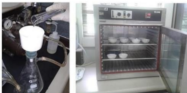
Figura 21. Determinación de Sólidos
