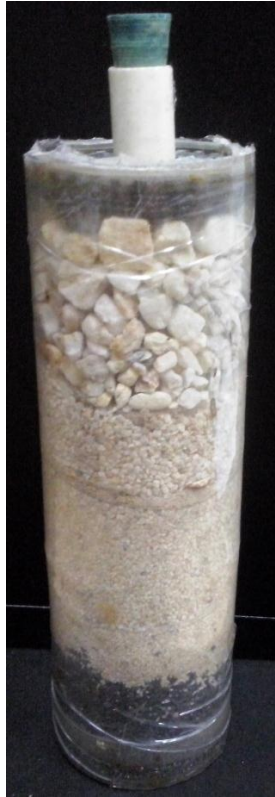
Figura 31. Sistema de filtración utilizado en el tratamiento terciario
