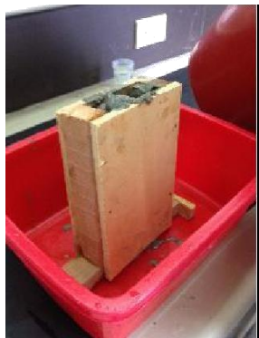
Figura 26. Vaciado de un muro en el micro- piloto
