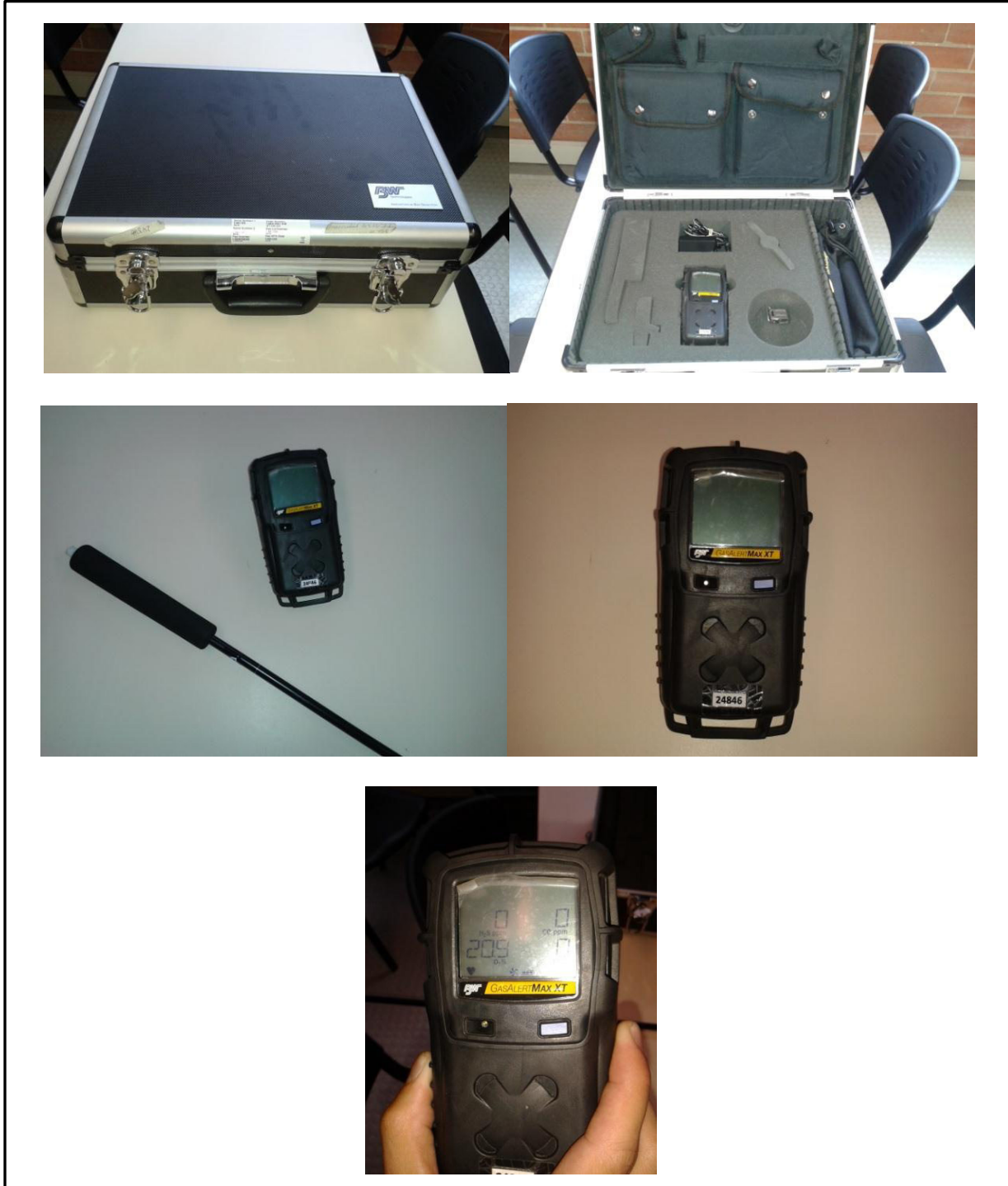
Figura 3. Equipo analizador de gases. Elaborado por los Autores
