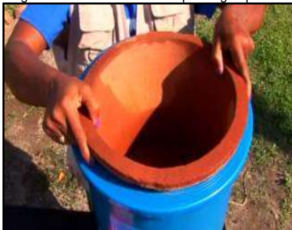
Figura 23. Filtro de cerámica para agua potable
