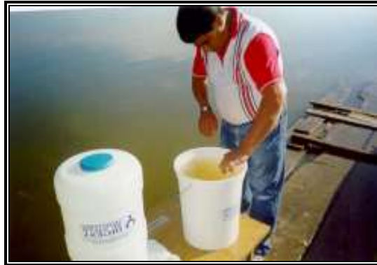
Figura 16. Adición de alumbre al agua.
