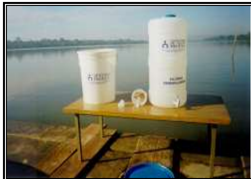
Figura 19. Principales elementos de la microfiltración con alumbre
