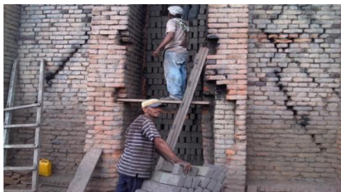
Figura 10: Proceso de cargue al horno. Fuente: Tomada por el autor
