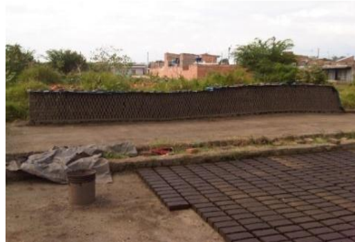
Figura 8: Secado y apilado. Fuente: Tomada por el autor.
