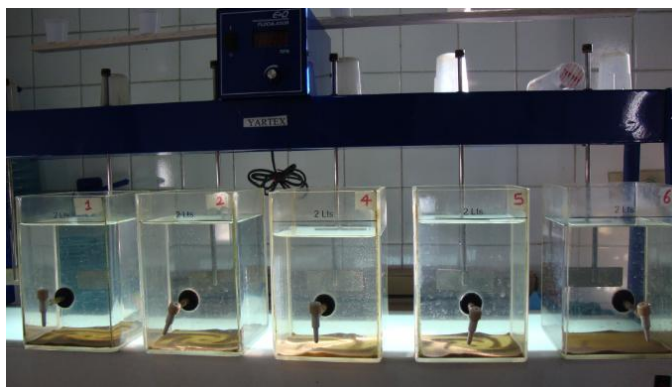
Figura 3- 3 Agua Clarificada bajo condiciones gradiente y tiempo óptimo
