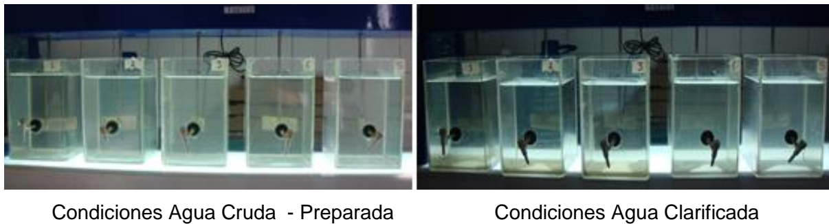
Figura 4- 3 Montaje Jar Test pH óptimo con Cal Dato No. 2
