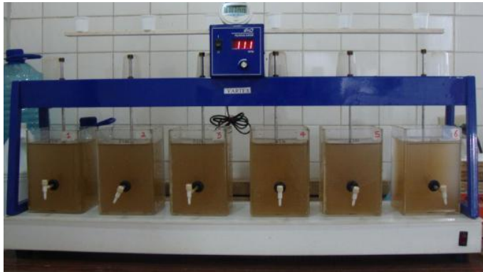
Figura 3- 2 Agua Clarificada en la determinación de dosis óptima
