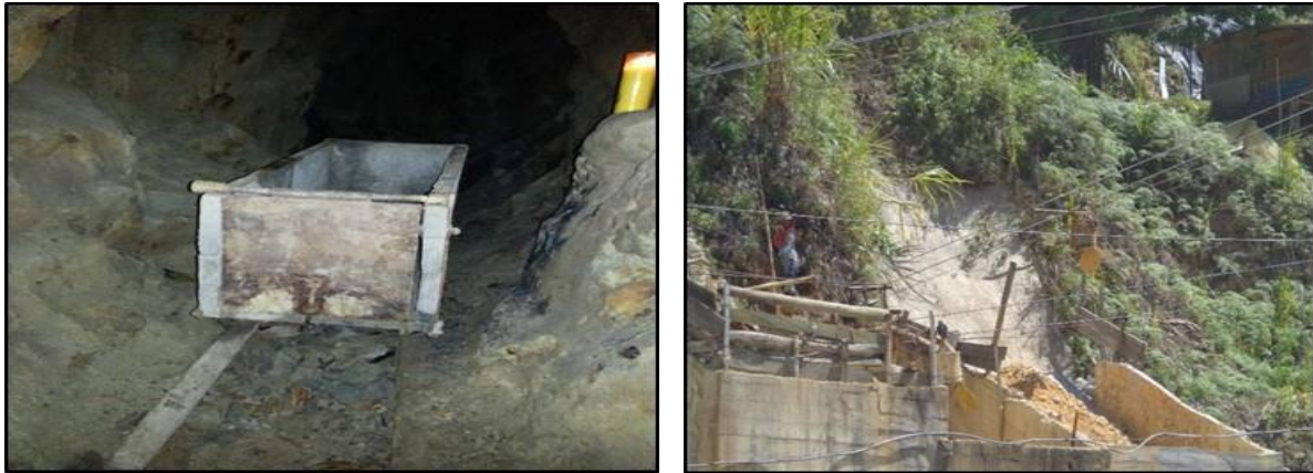
Gráfico No. 25. Transporte del Mineral por Vagones y Cable Aéreo
