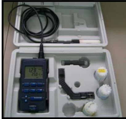
**Figura 16.** Equipo portátil utilizado en la determinación del oxígeno disuelto.
