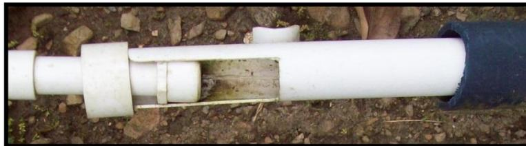
**Figura 39.** Dispositivo de regulación de caudal de la recámara dosificadora.
