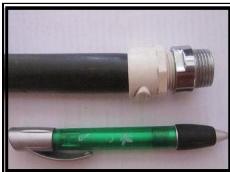
**Figura 20.** Restricción de flujo, adaptador macho y manguera.
