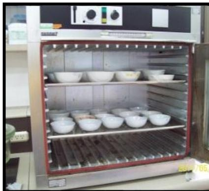
**Figura 14.** Estufa utilizada en la determinación de sólidos.
