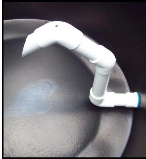
**Figura 31.** Dispositivo de salida de los reactores hidrolíticos.
