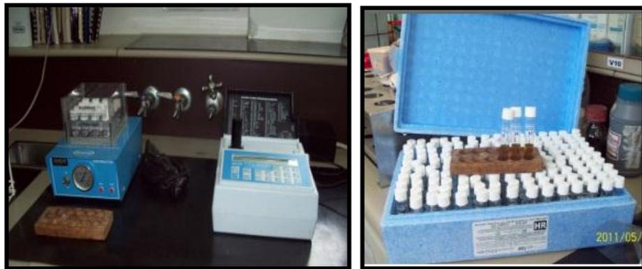
**Figura 13.** Digestor y espectrofotómetro y viales de alto rango utilizados para la determinación de la DQO.
