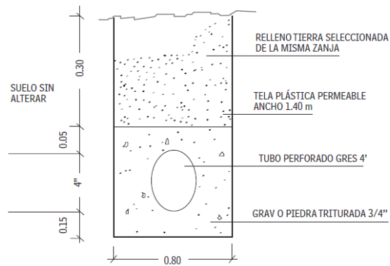
ZANJA DE INFILTRACIÓN - VISTA EN CORTE
