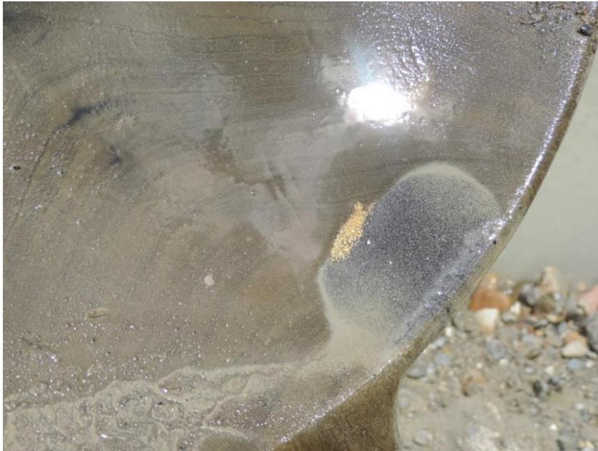
Figura 9. Batea, herramienta manual hecha en madera usada en el aprovechamiento artesanal de minerales.
