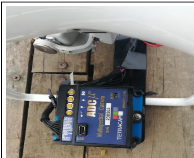
Figura 26. Cámara multispectral Tetracam ADC Micro adaptada al drone.
