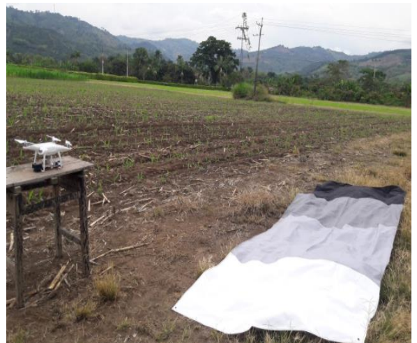
Figura 27. Tapete para calibrar las imágenes tomadas con la cámara multispectral.
