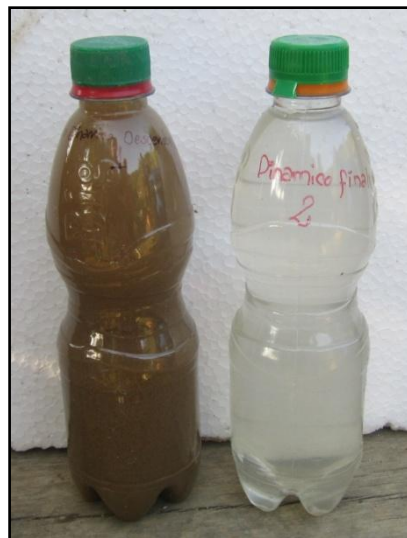
Figura 44. Agua inicial y final del retro lavado
