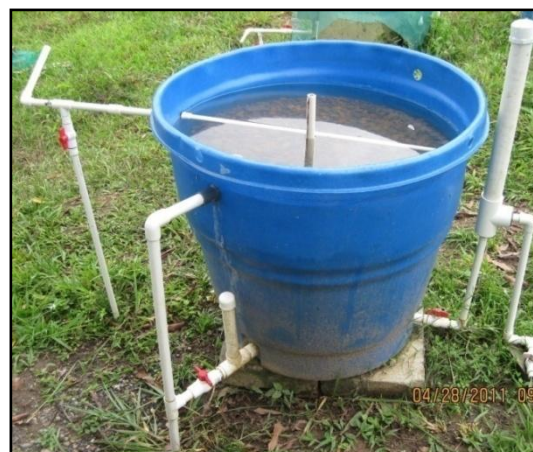
Figura 28. FGA en tanque de 250 litros
